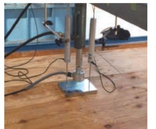
写真2 タイヤ接地面積荷重試験状況
