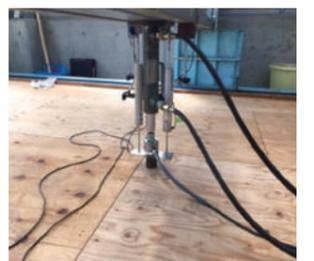
写真1 φ50集中荷重試験状況
